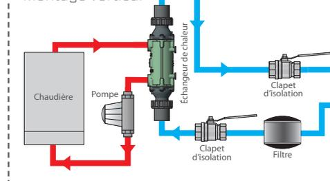
Si un système de dosage automatique est installé, il doit être positionné après l'échangeur de chaleur sur le retour depuis la piscine.
