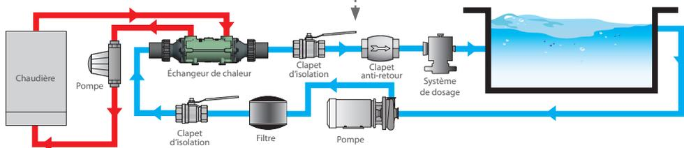
Si un système de dosage automatique est installé, il doit être positionné après l'échangeur de chaleur sur le retour depuis la piscine.
